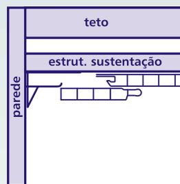
**7** Com o lado refilado direcionado para o rodaforno, encaixe as duas extremidades do perfil nos rodafornos laterais, mesmo que fique sobreposta ao perfil anterior;
