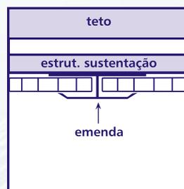
**10** Caso o comprimento do perfil não for suficiente para cobrir seu vão, utilize a "emenda" para unir os perfis. Pode ser necessário colocar um elemento extra na estrutura para fixá-la.
