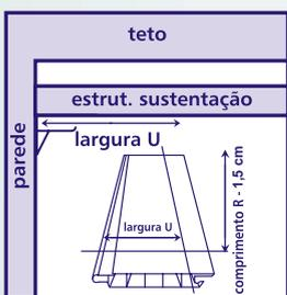
**6** Para colocar o último perfil, corte no comprimento R 1,5cm a menos que as demais. Meça o espaço entre a parte interna do encaixe fêmea da última lâmina colocada e o final do arremate.
