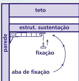
**5** Fixe o perfil em cada parte da estrutura, através da aba de fixação. Corte os demais perfis como o primeiro, encaixe o engate macho no fêmea do perfil anterior e fixe cada perfil na estrutura;
