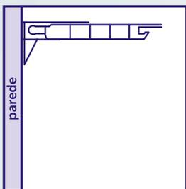
**4** Coloque o perfil, com a face aparente direcionada para baixo e o engate macho voltado para o fundo, dentro do vão dos rodafornos laterais;
